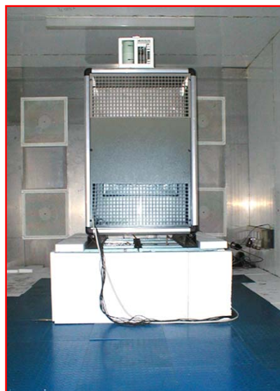
Die Bilder zeigen eine für Altbauten entwickelte CO 2 -Wärmepumpe bei Labormessungen und im Feldversuch
