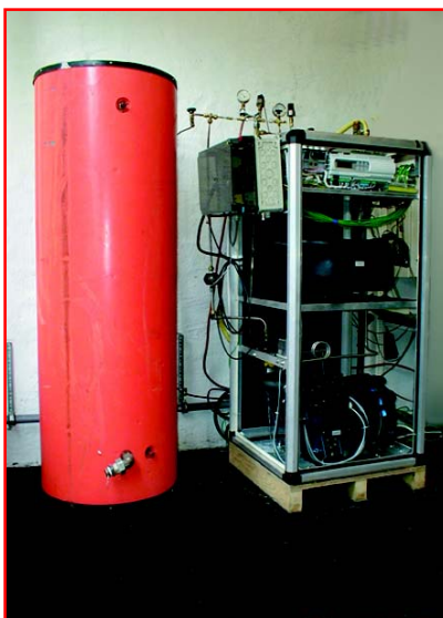
Die Bilder zeigen eine für Altbauten entwickelte CO 2 -Wärmepumpe bei Labormessungen und im Feldversuch
